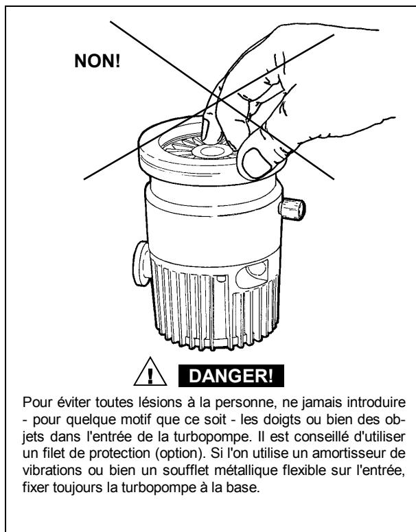
La turbopompe peut être installée dans n'importe quelle position. Fixer la turbopompe dans une position stable en reliant la bride d'entrée à une contre-bride fixe pouvant supporter un couple de 200 Nm autour de son axe, ou bien en utilisant le kit en option prévu pour un fixation à la base de la pompe.
