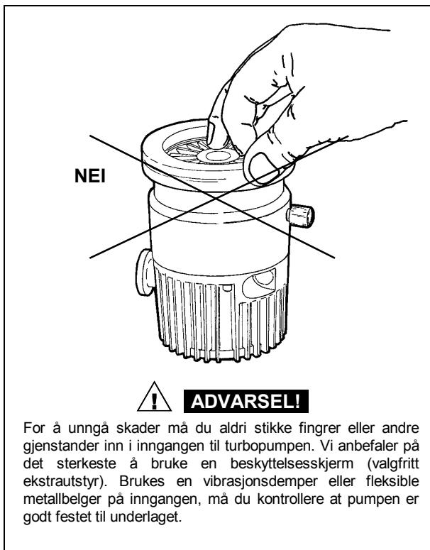
Turbopumpen kan monteres i en valgfri stilling. Fest turbopumpen i en stabil stilling med inngangsflens festet mot en koplingsflens med et dreiemoment på 200 Nm rundt aksen, eller ved å bruke bunnfestesettet.
