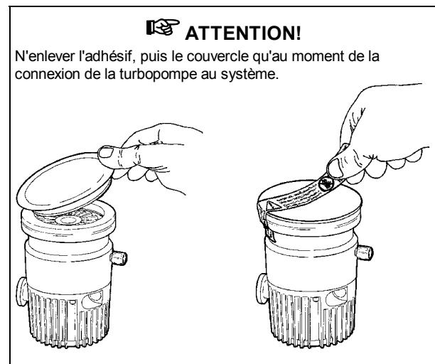
La turbopompe devra être installée en position verticale ou en position retournée avec une inclinaison maximum de 10° par rapport à l'axe vertical.
