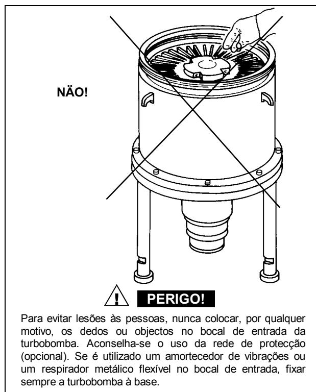
Para evitar lesões às pessoas, nunca colocar, por qualquer motivo, os dedos ou objectos no bocal de entrada da turbobomba. Aconselha-se o uso da rede de protecção (opcional). Se é utilizado um amortecedor de vibrações ou um respirador metálico flexível no bocal de entrada, fixar sempre a turbobomba à base.
