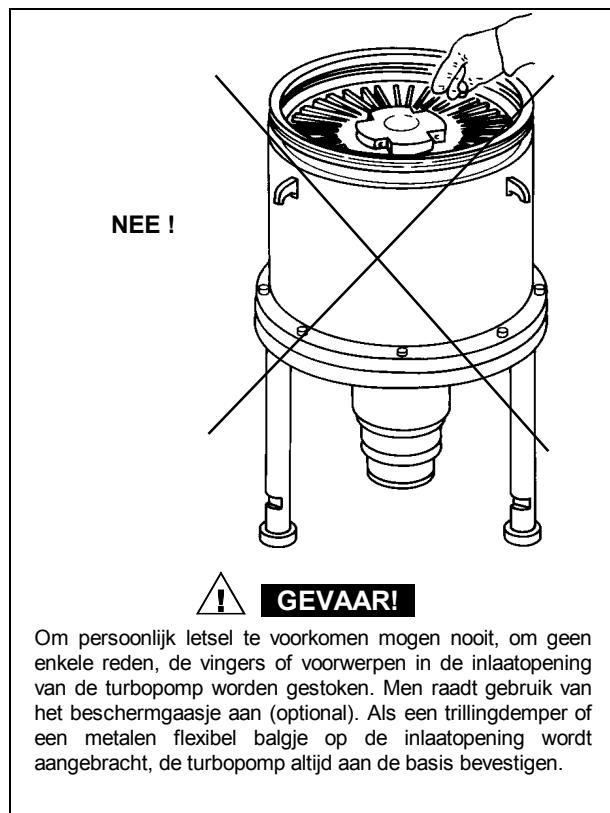
Om persoonlijk letsel te voorkomen mogen nooit, om geen enkele reden, de vingers of voorwerpen in de inlaatopening van de turbopomp worden gestoken. Men raadt gebruik van het beschermgaasje aan (optional). Als een trillingdemper of een metalen flexibel balgje op de inlaatopening wordt aangebracht, de turbopomp altijd aan de basis bevestigen.
