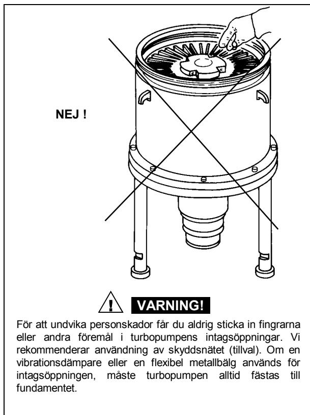
För att undvika personskador får du aldrig sticka in fingrarna eller andra föremål i turbopumpens intagsöppningar. Vi rekommenderar användning av skyddsnätet (tillval). Om en vibrationsdämpare eller en flexibel metallbälge används för intagsöppningen, måste turbopumpen alltid fästas till fundamentet.
