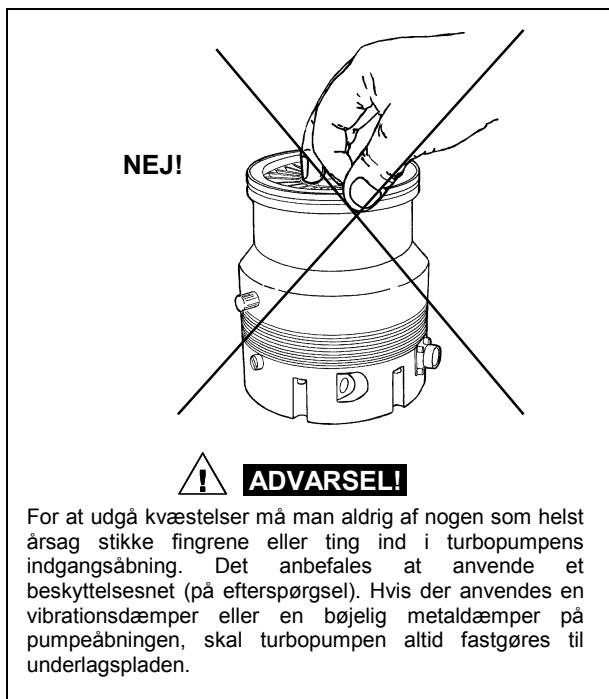
Turbopumpen kan monteres i hvilken som helst stilling. Den fastspændes ved, at turbopumpens indgangsflange fastgøres til en fast modflange, der er i stand til at modstå et drejningsmoment på 1000 Nm omkring aksen.
