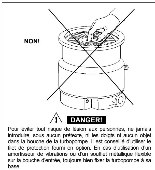
Pour éviter tout risque de lésion aux personnes, ne jamais introduire, sous aucun prétexte, ni les doigts ni aucun objet dans la bouche de la turbopompe. Il est conseillé d'utiliser le filet de protection fourni en option. En cas d'utilisation d'un amortisseur de vibrations ou d'un soufflet métallique flexible sur la bouche d'entrée, toujours bien fixer la turbopompe à sa base.
