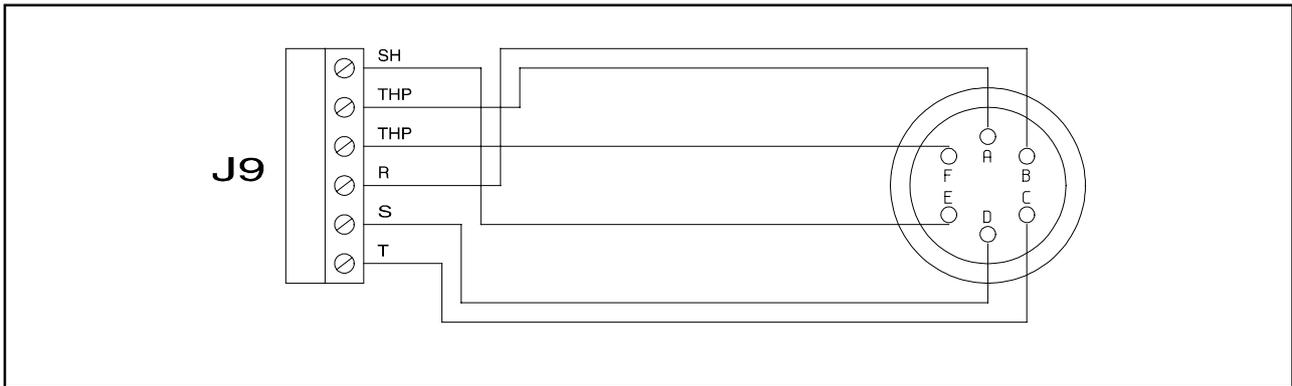
Forbindelseskabel mellom styreenhet og pump
