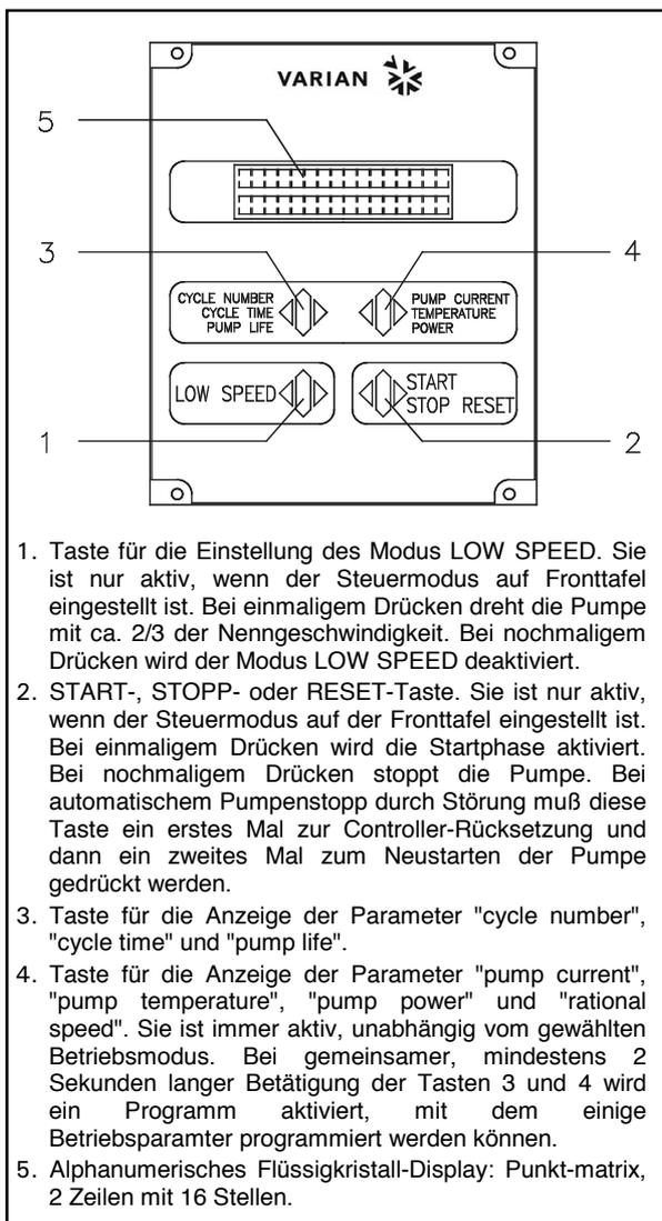
1. Taste für die Einstellung des Modus LOW SPEED. Sie ist nur aktiv, wenn der Steuermodus auf Fronttafel eingestellt ist. Bei einmaligem Drücken dreht die Pumpe mit ca. 2/3 der Nenngeschwindigkeit. Bei nochmaligem Drücken wird der Modus LOW SPEED deaktiviert.
