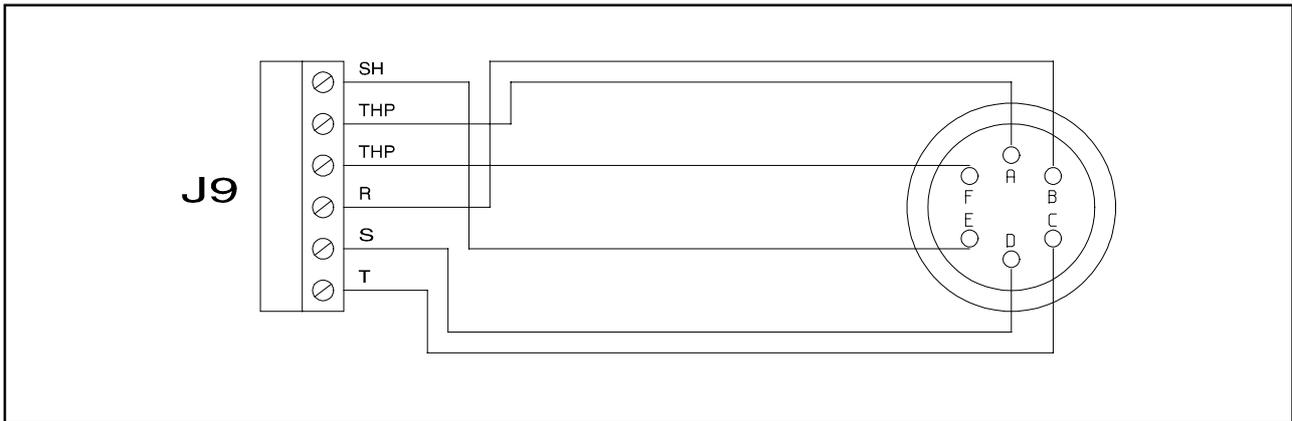
Verbundkabel zwischen Controller und Pumpe
