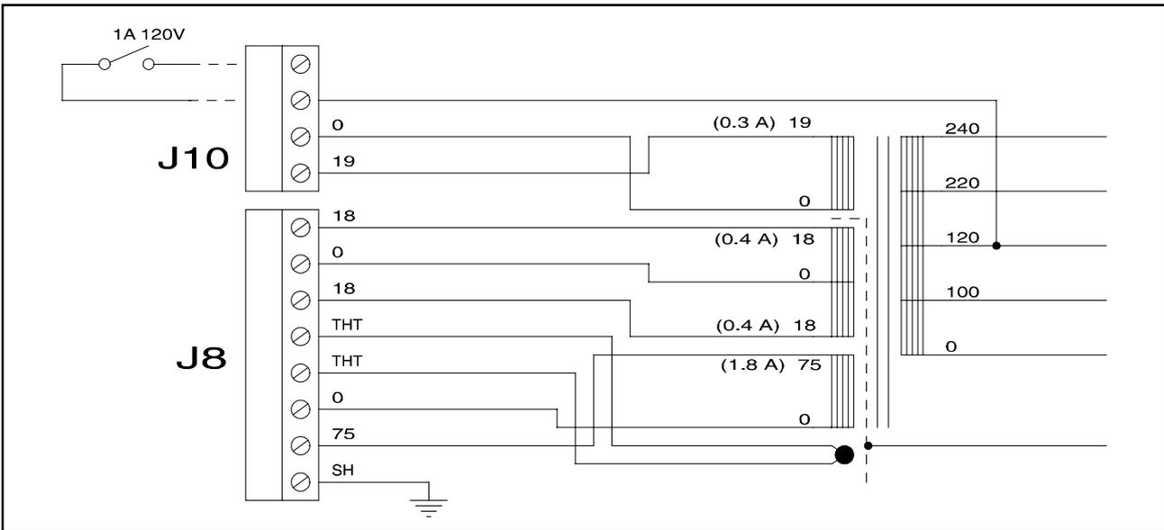
Verbundkabel zwischen Controller und Transformator
