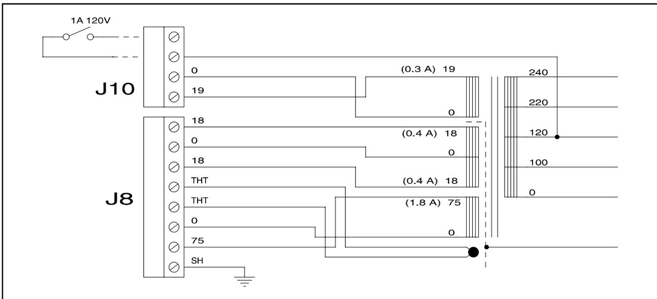
Forbindelseskabel mellom styreenhet og transformator
