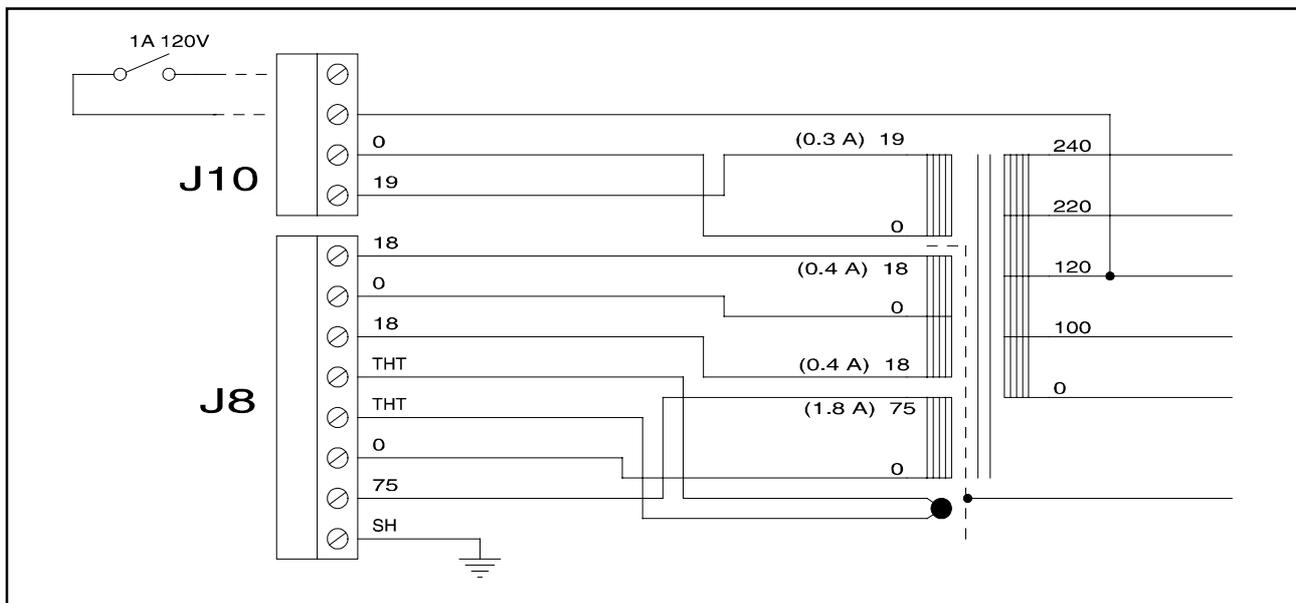
*Interconexões entre o controller e o transformador*
