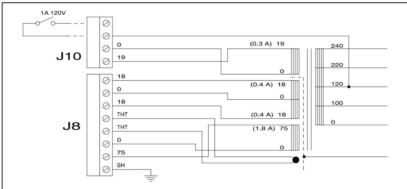
Forbindelseskabel mellem styreenhed og transformator
