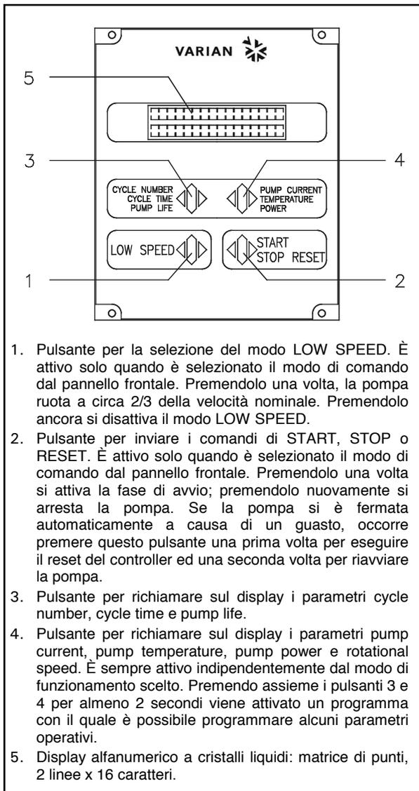
1. Pulsante per la selezione del modo LOW SPEED. È attivo solo quando è selezionato il modo di comando dal pannello frontale. Premendolo una volta, la pompa ruota a circa 2/3 della velocità nominale. Premendolo ancora si disattiva il modo LOW SPEED.
