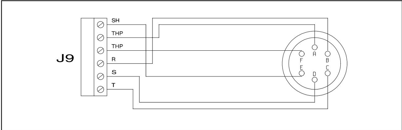
Cable de interconexión entre el controler y la bomba
