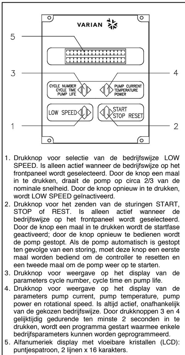
1. Drukknop voor selectie van de bedrijfswijze LOW SPEED. Is alleen actief wanneer de bedrijfswijze op het frontpaneel wordt geselecteerd. Door de knop een maal in te drukken, draait de pomp op circa 2/3 van de nominale snelheid. Door de knop opnieuw in te drukken, wordt LOW SPEED geïnactiveerd.
