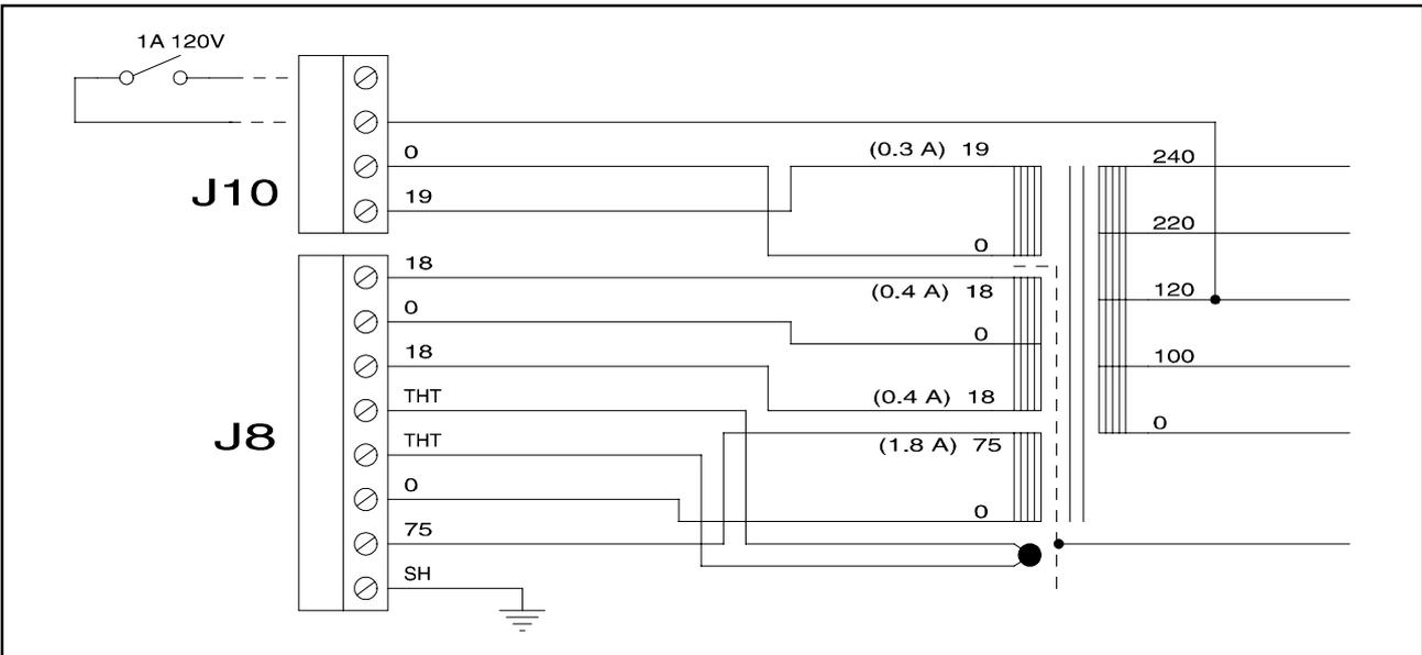
Verbindingskabel tussen controller en transformator
