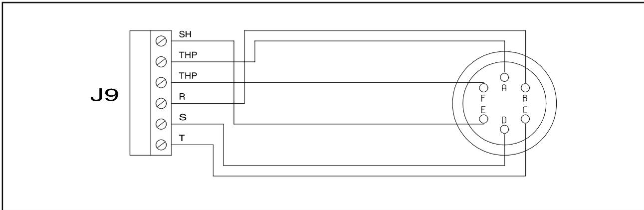
Forbindelseskabel mellem styreenhed og pump
