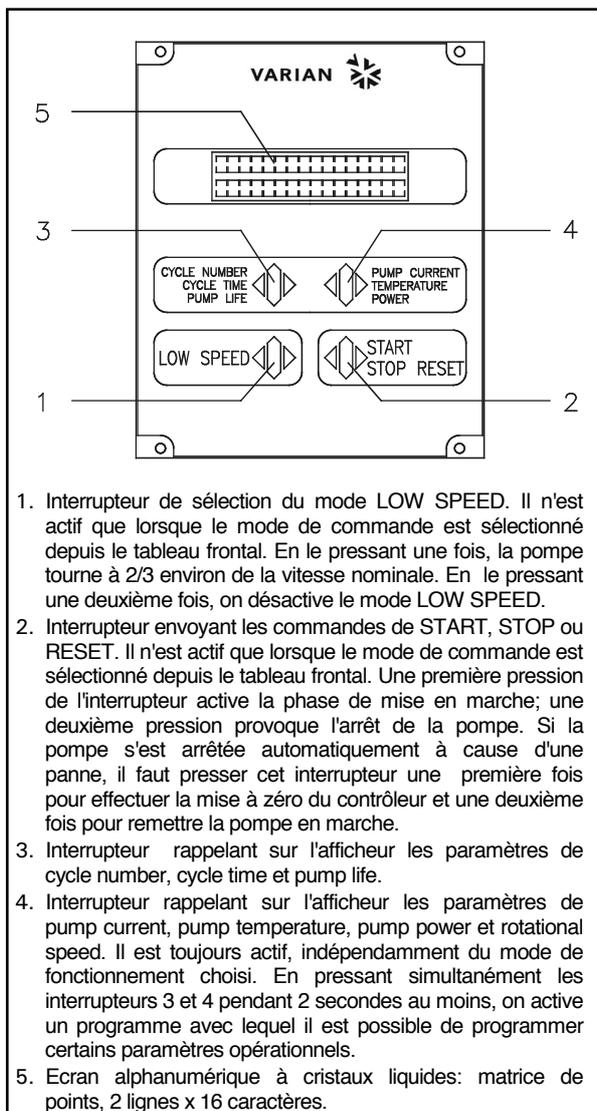
1. Interrupteur de sélection du mode LOW SPEED. Il n'est actif que lorsque le mode de commande est sélectionné depuis le tableau frontal. En le pressant une fois, la pompe tourne à 2/3 environ de la vitesse nominale. En le pressant une deuxième fois, on désactive le mode LOW SPEED.
