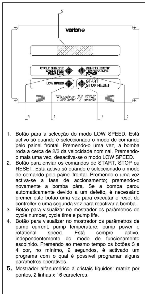
1. Botão para a selecção do modo LOW SPEED. Está activo só quando é seleccionado o modo de comando pelo painel frontal. Premendo-o uma vez, a bomba roda a cerca de 2/3 da velocidade nominal. Premendo-o mais uma vez, desactiva-se o modo LOW SPEED.
