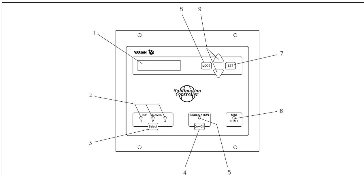
Schalter und Anzeigen auf der vorderen Schalttafel des Sublimation-Controllers
