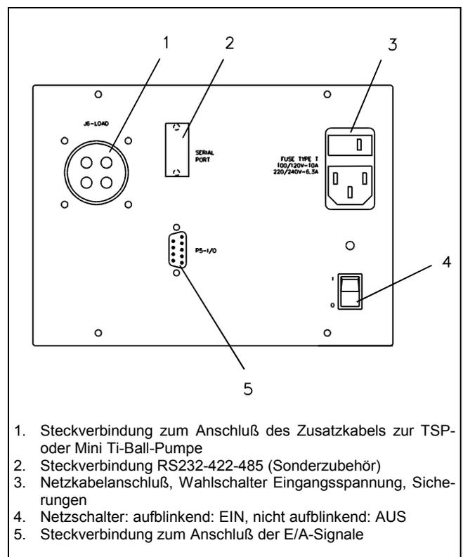
1. Steckverbindung zum Anschluß des Zusatzkabels zur TSP- oder Mini Ti-Ball-Pumpe
