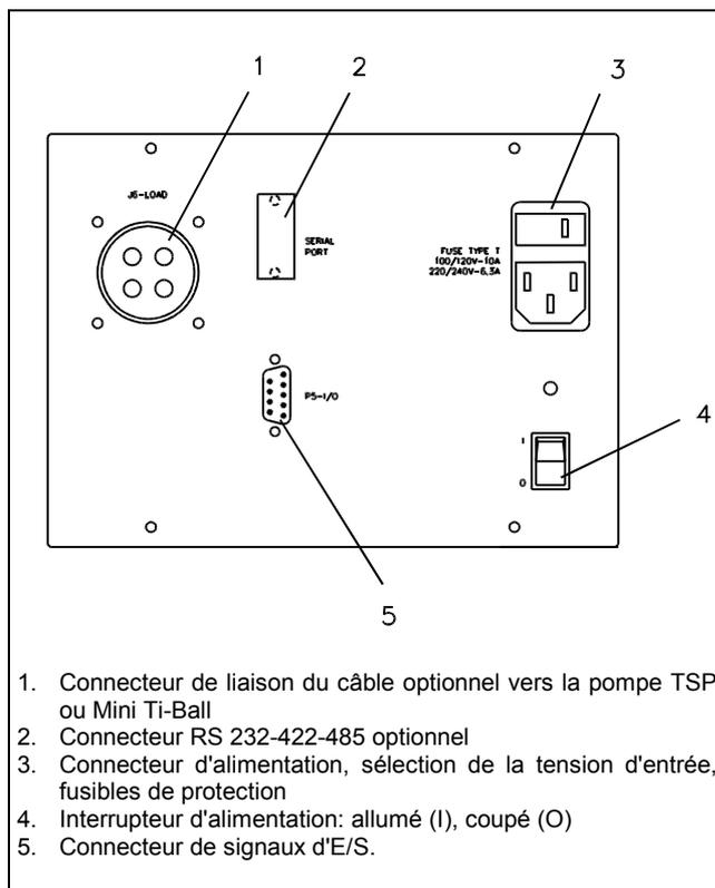
1. Connecteur de liaison du câble optionnel vers la pompe TSP ou Mini Ti-Ball
