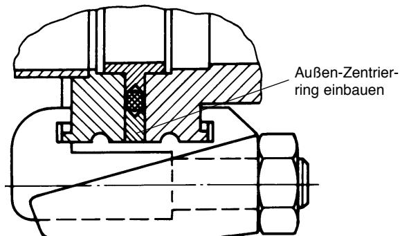
Abb. 4 Verwendung von ISO-K-Flanschen
