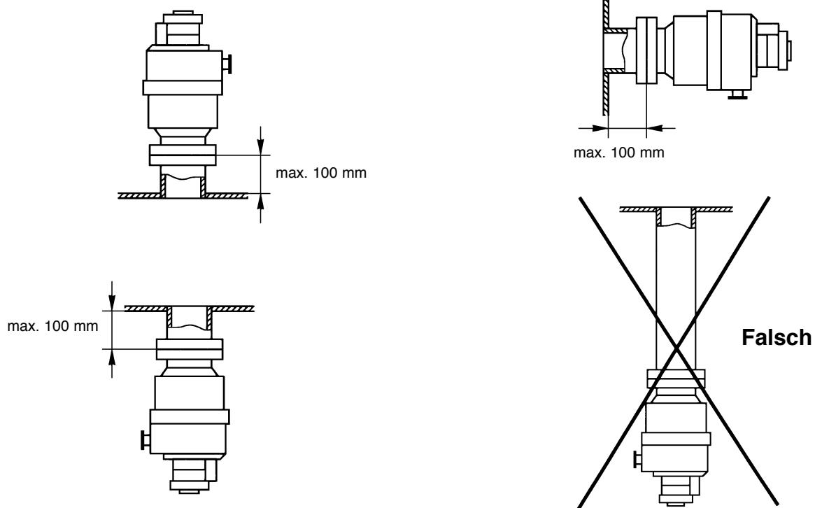
Abb. 3 Feste Anflanschung der TURBOVAC an den Vakuumbehälter
