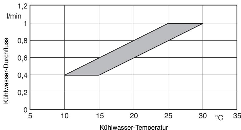
Abb. 5 Kühlwasserbedarf
