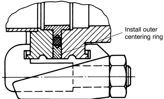
Fig. 4 Using ISO-K flanges
