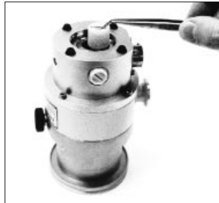
Fig. 14 Betriebsmittelspeicher entnehmen Remove operating fluid reservoir Enlever le réservoir de fluide moteur
